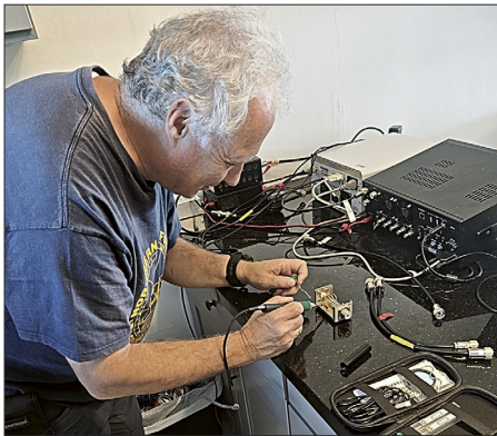
Olaf, DL7JOM, überprüft das kleine Bandpassfilter für 6 m.
